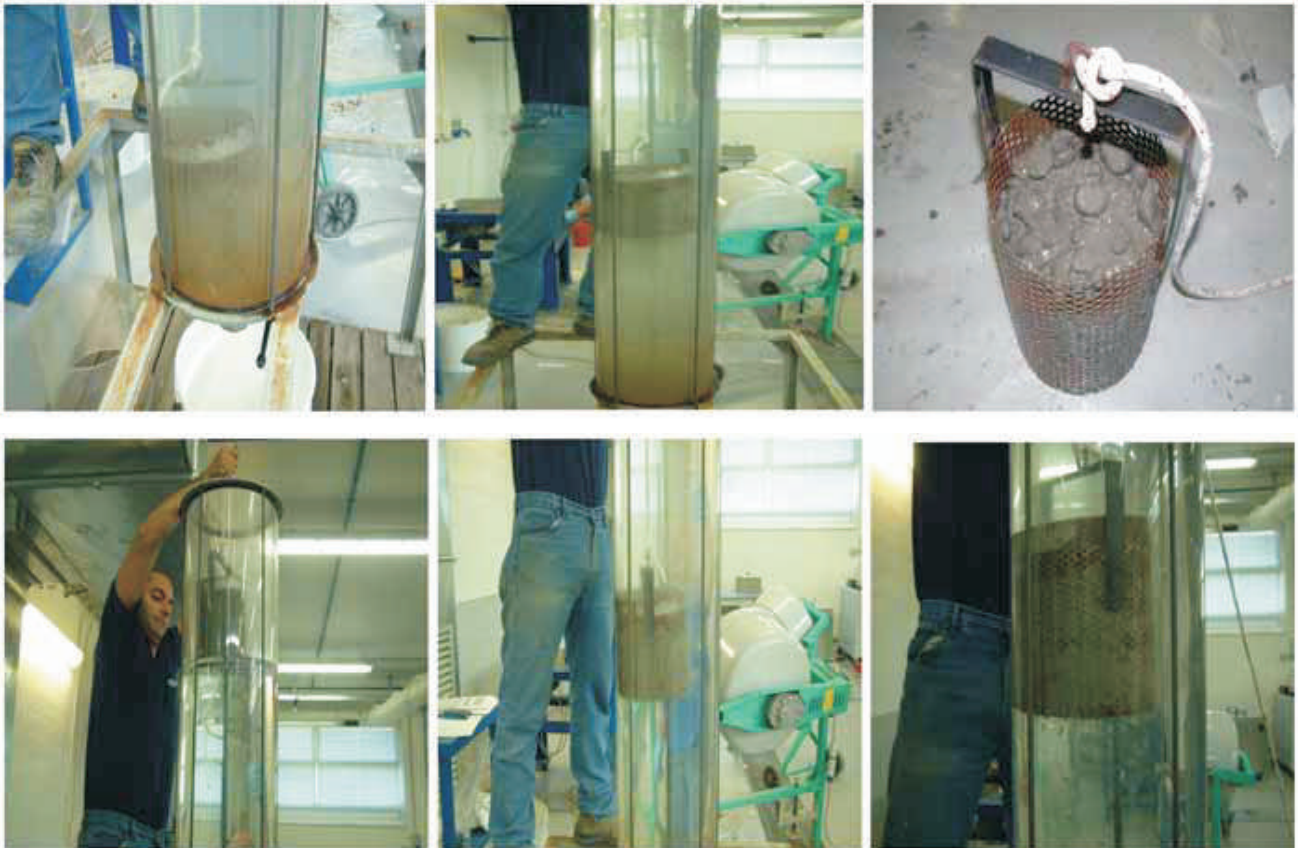
Определение выщелачивания и внешний вид бетона после испытания.
