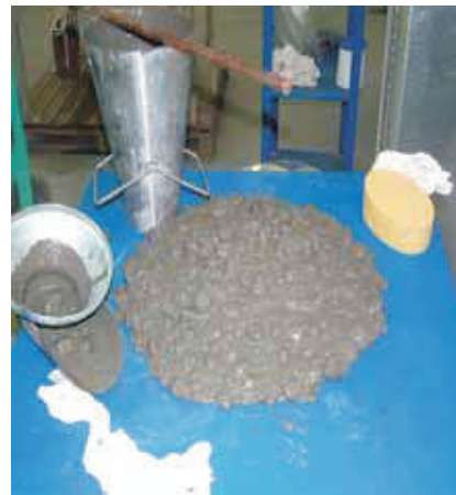
Внешний вид бетона после теста на начальную осадку конуса.
